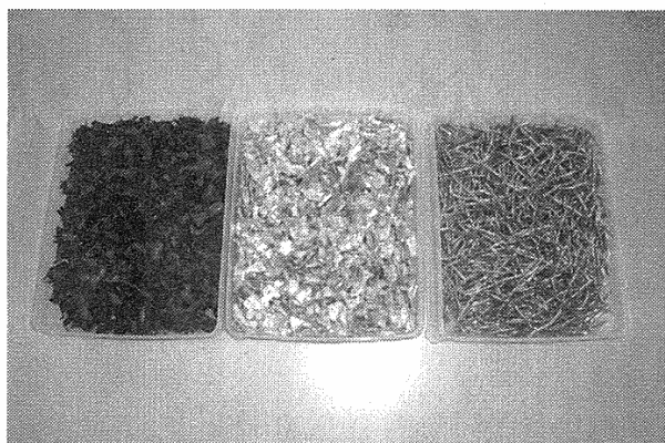
異素材混合物の一つである同軸ケーブル(右)と分離・処理された樹脂とアルミニウムと銅(左、ともにエムダイヤ提供)
