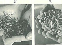
鉄心(左)と高強度樹脂(右)に分離・破碎
