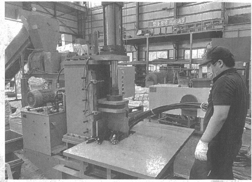
同社が開発したプラントに光ケーブルを投入し分離・破碎することで、樹脂と金属に分けることができる
