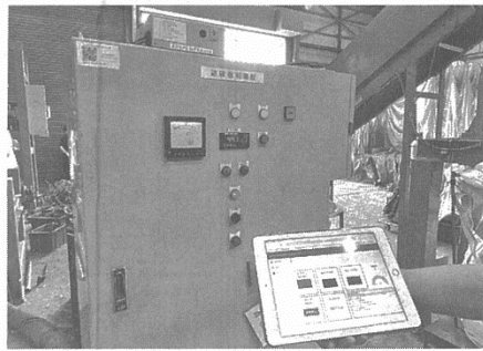
リサイクル機械を独自開発のIoTを活用した装置で遠隔監視
