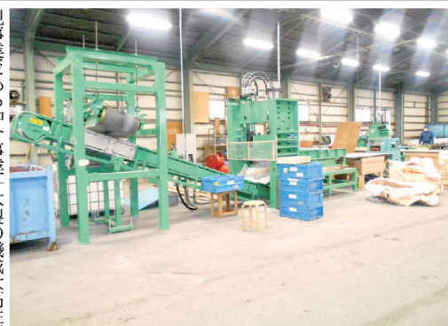
工場に設置した廃アルミ線処理設備
