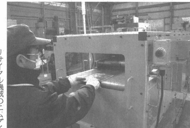
分解機に基板を入れると、2つの刃がチップなどを剥ぎ取る。機械はデザインを改良した後に発売する
