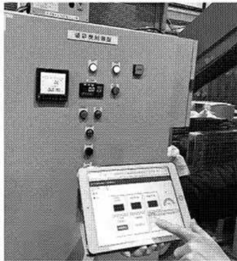
タブレットなどを使い、遠方からリサイクル機械を監視できる
