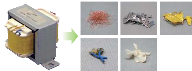
↑トランスは金属片と樹脂と銅線に分離・破碎される。レアメタルを含む機器の分離・破碎にも威力を発揮すると期待されている。
