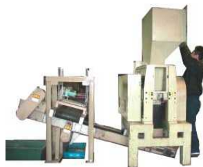
↑エコセパレ MTR-200 型の設置事例。右/分離・処理機、左/磁選機、中央の左上がりはベルトコンベア。（必要スペース：W2600 × D1700 × H2300mm）
